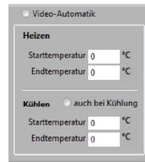
reagiert die Automatik auf die fallende Temperatur. Ohne diese Option wird nur bei steigenden Temperaturen eine Video-Aufnahme automatisch durchgeführt.
