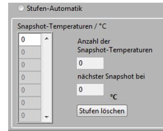
Während des Automatikbetriebes werden die Anzahl der Stufen und die nächste Snapshot-Temperatur in den nebenstehenden Feldern angezeigt.
