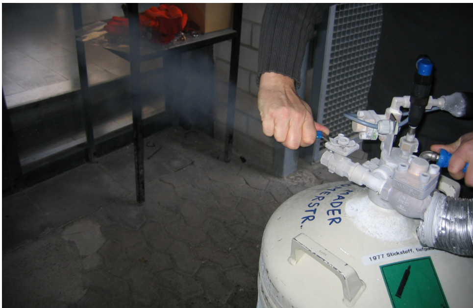
Abb7: Druckentlastung nach erfolgter Abfüllung.
